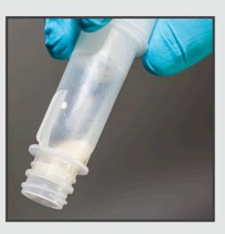
> Agiter le tube jusqu'à obtention d'une solution laiteuse.
