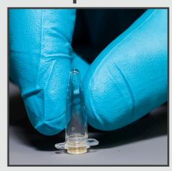
> Incuber le tube à l'envers pendant 2 minutes (utiliser un chronomètre) à température ambiante pour reconstituer les réactifs dans le capuchon.
