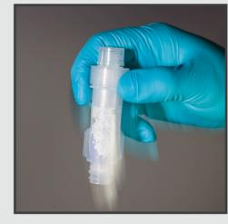
> Mélanger l'echantillon lysé avec la poudre dans le tube d'absorbant en agitant minutieusement.
