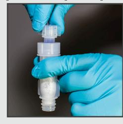
> Visser le tube chauffant sur le tube d'absorbant.
