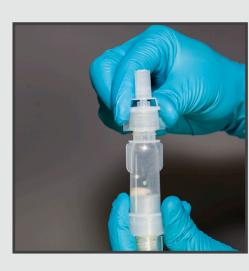
> Visser le capuchon d'injection sur l'autre côté du tube d'absorbant.
