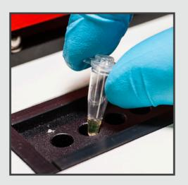
> Incuber le tube de réaction à 67 °C pendant 40 minutes dans l'unité de réaction. La réaction est automatiquement inactivée par une nouvelle étape d'incubation à 80 °C pendant 5 minutes.
