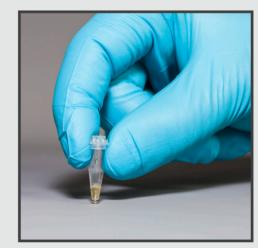
Agiter le tube de réaction jusqu'à ce que le mélange de réaction se dépose au fond du tube.
