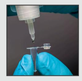
> Extraire 30 µl de l'ADN directement dans le tube de réaction en pressant le tube d'absorbant.
