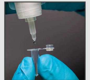
> Extraiga 30 µl de ADN directamente en el tubo de reacción apretando el tubo adsorbente.
