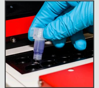
> Incube el tubo en la unidad de calentamiento de Huma-Loop T durante 5 min a 90 °C.
