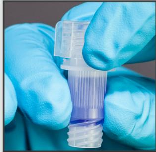
> Retire la tapa del tubo de calentamiento de Loopamp™ PURE DNA Extraction Kit.
