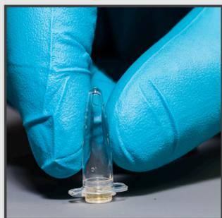
> Incube el tubo boca abajo durante 2 min (utilice un cronómetro) a temperatura ambiente para reconstituir los reactivos en el tapón.
