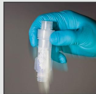
> Mezcle la muestra lisada con el polvo del tubo adsorbente agitando cuidadosamente.
