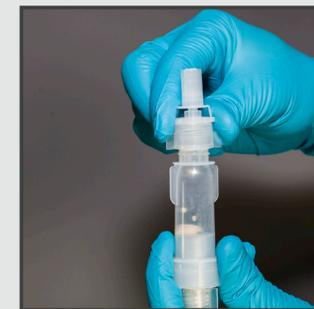
> Enrosque el tapón de inyección con el otro lado del tubo adsorbente.
