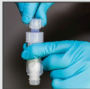
> Enrosque el tubo de calentamiento al tubo adsorbente.
